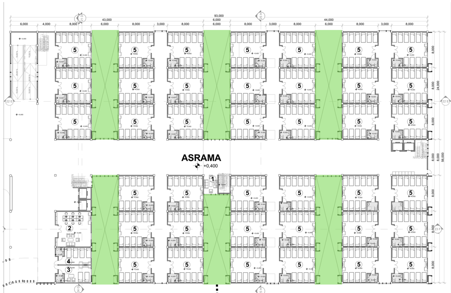
Gambar 5.6: Jarak antar massa bangunan asrama Sumber: penulis
