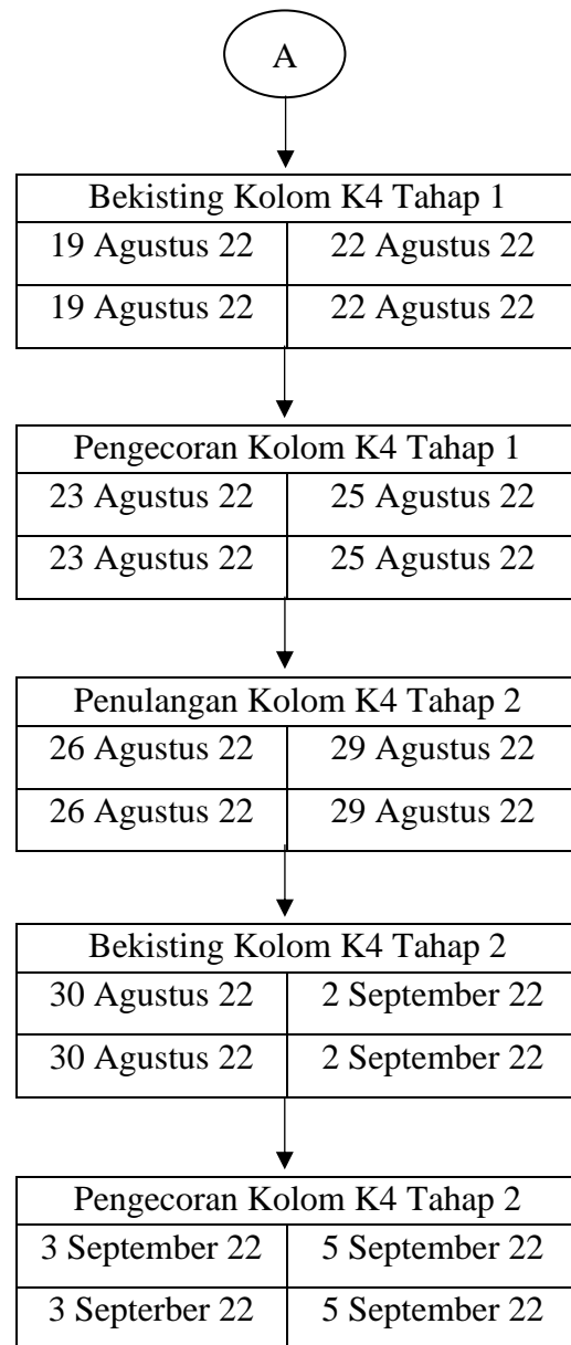
Gambar 5.13 Pekerjaan Kolom K3 dan K4 Sebelum Mengalami Percepatan
