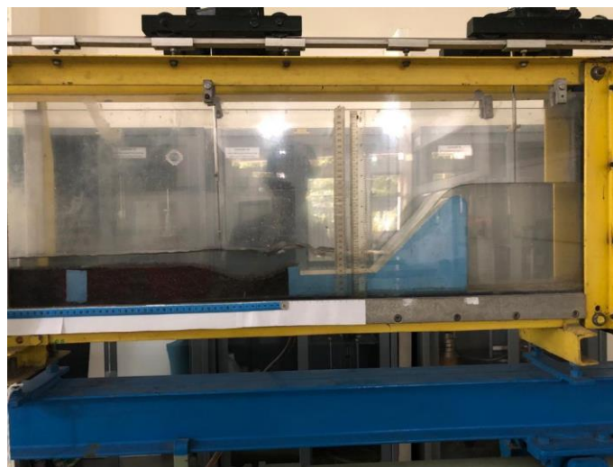
Gambar 5.12 Percobaan Pengamatan Gerusan dengan Groundsill h_0 0,180
