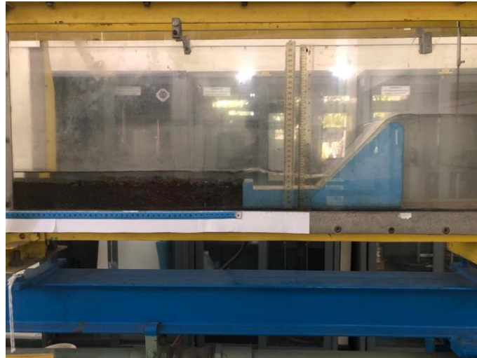
Gambar 5.19 Percobaan Pengamatan Gerusan dengan L_{maks} Riprap h_0 0,175 m
