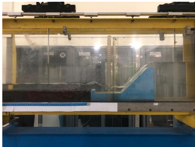
Gambar 5.25 Percobaan Pengamatan Gerusan dengan \frac{1}{2} L_{maks} Riprap h_0 0,185
