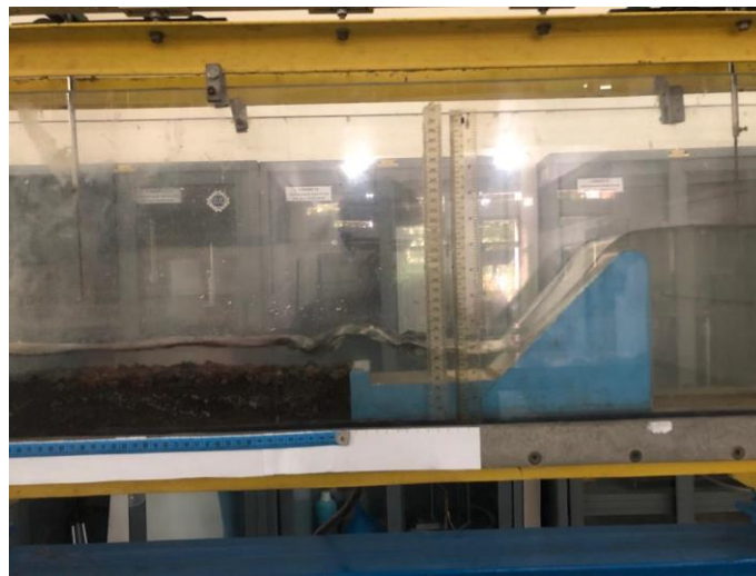
Gambar 5.21 Percobaan Pengamatan Gerusan dengan L_{maks} Riprap h_0 0,180 m
