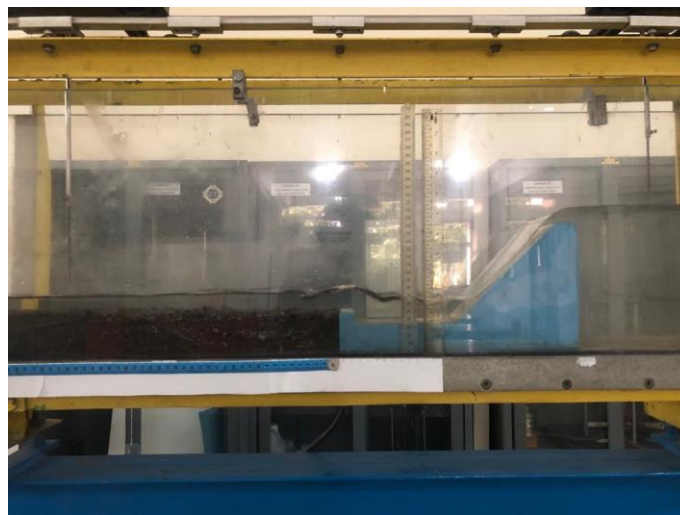
Gambar 5.23 Percobaan Pengamatan Gerusan dengan L_{maks} Riprap h_0 0,185 m
