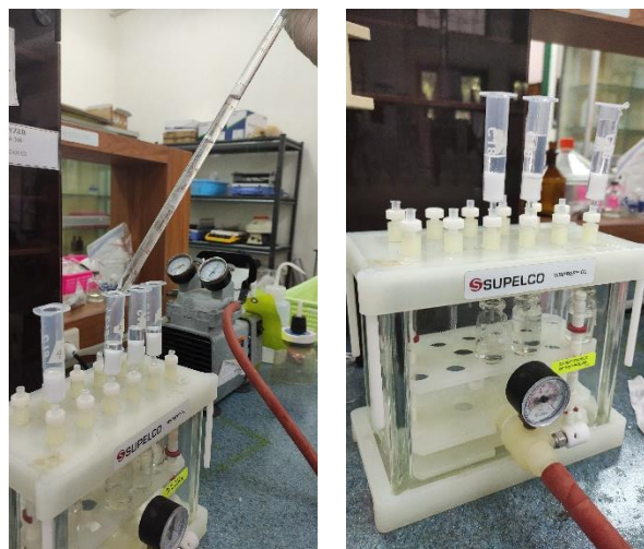
Gambar 3. 13 Proses Conditioning, Loading Sample, Vaccum Dry, Ellution pada sampel menggunakan katrid C18-E
