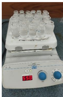
Gambar 3. 7 Proses preparasi sampel dengan menggunakan hotplate (sumber : dokumentasi pribadi, 2023)
