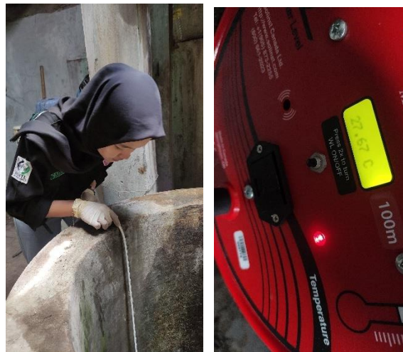
Gambar 3. 2 Pengukuran menggunakan alat water level meter (sumber : dokumentasi pribadi, 2023)
