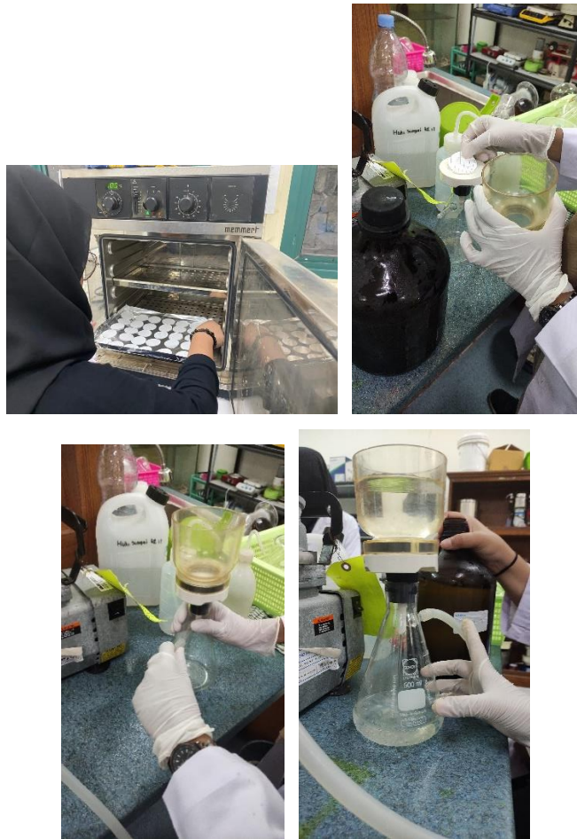
Gambar 3. 11 Proses penyaringan sampel menggunakan kertas saring glass micro-fiber 0,45 \mu\text{m} dengan alat vaccum (sumber : dokumentasi pribadi, 2023)
