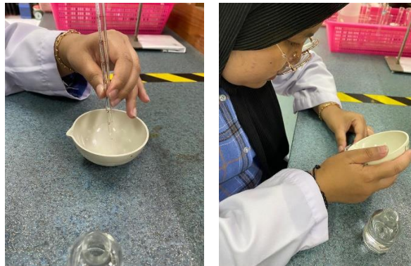
Gambar 3. 9 Proses Derivatisasi dengan Melarutkan 1 mL Aseton Pada Cawan Porselin (Sumber: dokumentasi pribadi, maret 2023)
