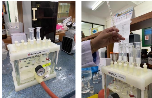
Gambar 3. 7 Proses Conditioning, Loading Sample, Vacuum Dry, Elution Pada Sampel Menggunakan Cartridge C18-E
