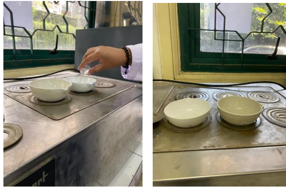
Gambar 3. 8 Proses Dryness Pada Sampel Menggunakan Waterbath (Sumber: dokumentasi pribadi, maret 2023)
