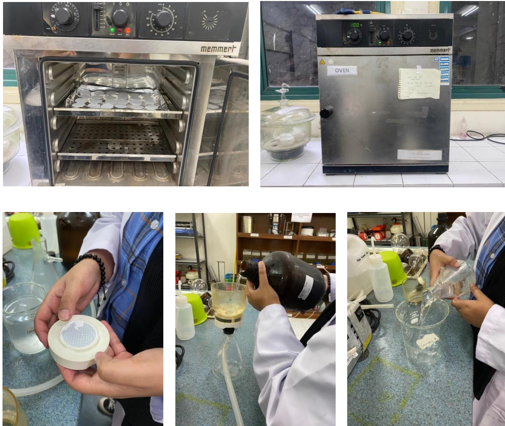
Gambar 3. 6 Proses Pengovenan Kertas Saring dan Penyaringan Sampel (Sumber: dokumentasi pribadi, Maret 2023)
