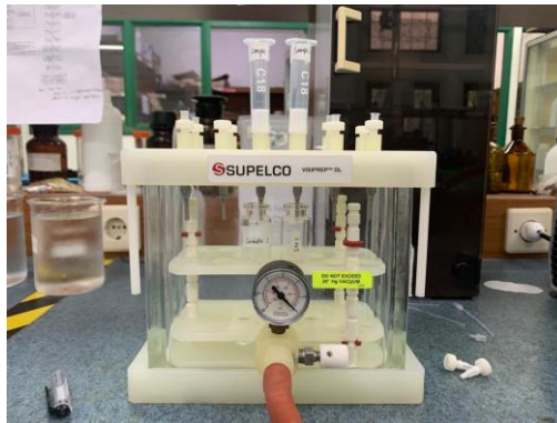
Gambar 3. 8 Proses Conditioning, Loading sample, Vacuum dry, Elution pada Sampel Menggunakan Catridge C18-E (Sumber : Dokumentasi pribadi, 2023)
