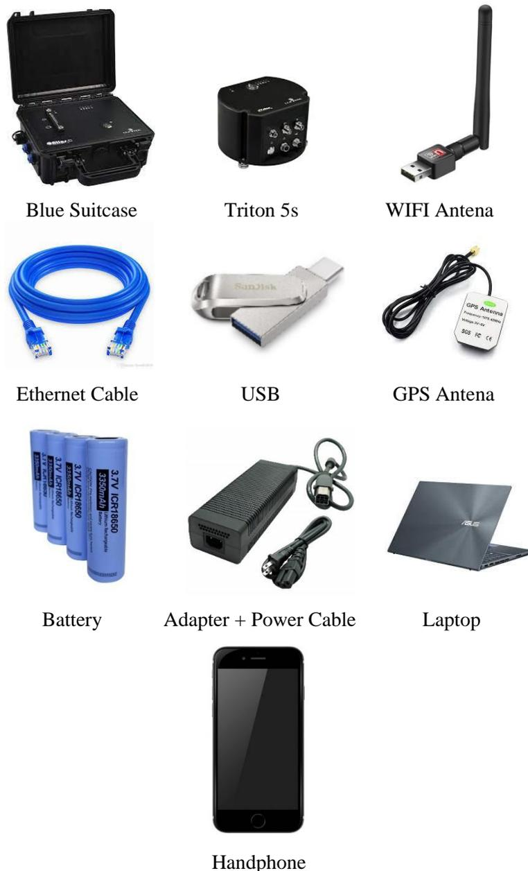
**Gambar 4.2 Perangkat Keras Pengukuran Mikrotremor**
