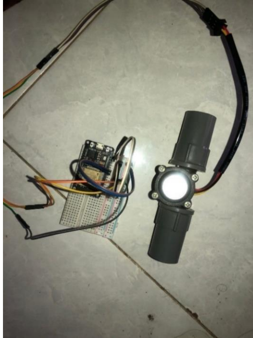
Gambar 3.6 Konfigurasi ESP32 dan Waterflow sensor
