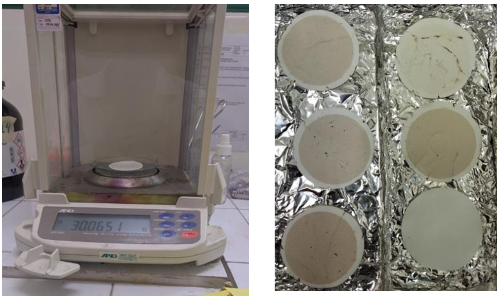
Gambar C. 3 Penimbangan Kertas TSS (kiri) dan Hasil Penyaringan TSS (kanan)
