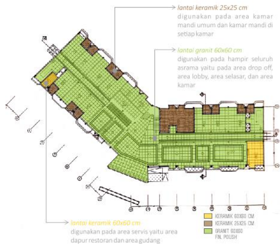
Rencana Pola Lantai 1 Asrama MMTC Blok III Yogyakarta sumber: PT. Arsigraphi, 2017
