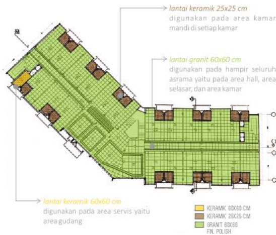
Rencana Pola Lantai Tipikal Asrama MMTc Blok III Yogyakarta sumber: PT. Arsigraphi, 2017
