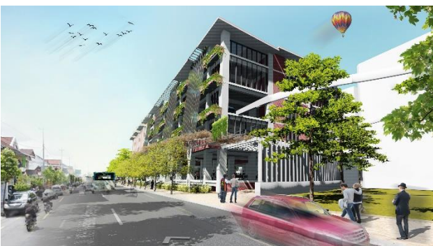
Gambar 7. Fasad Semi terbuka untuk mengalirkan udara kedalam bangunan Sumber: Penulis, 2017
