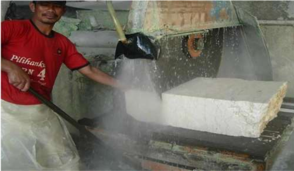
Proses Pemoangan Batu Marmer Menggunakan Mesin Potong Gerinda
