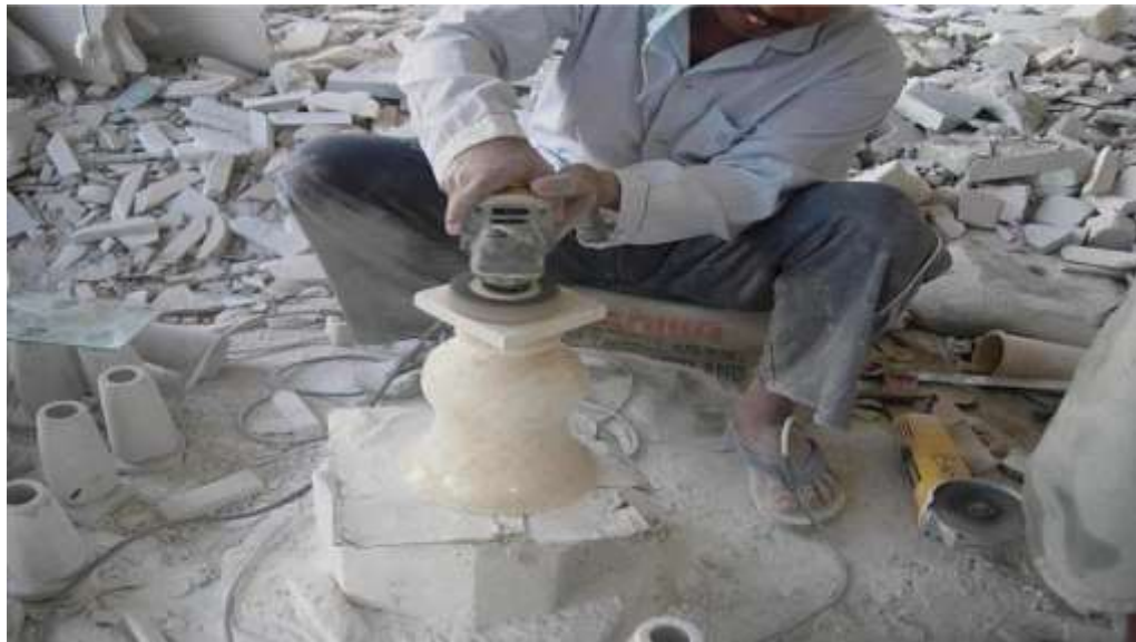
Proses Penghalusan Batu Marmer Menggunakan Mesin Ampas
