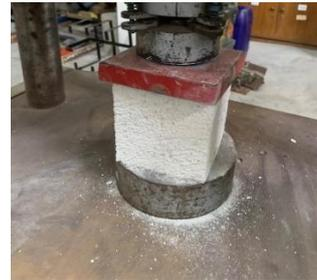
Gambar 5. *Setting up* pengujian kuat tekan
