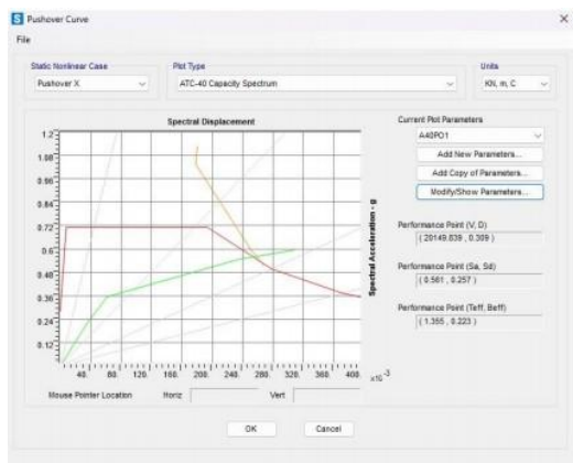
Gambar 11. Capacity Spectrum Arah X dengan Gempa MCE_R
