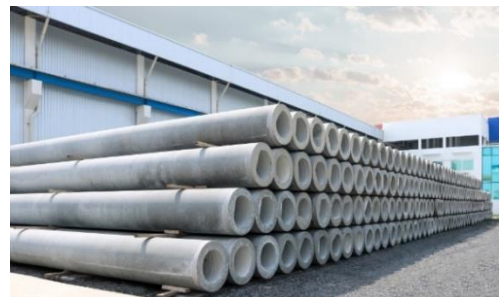
Gambar 1. Tiang Pancang Spun Pile
