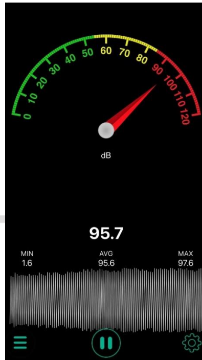
Lampiran 13. Hasil pengukuran Soundmeter pada area proses kerja penggilingan kedelai
