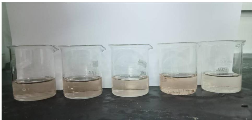
Penambahan HNO 3 pekat pada filtrat hasil elektrokoagulasi
