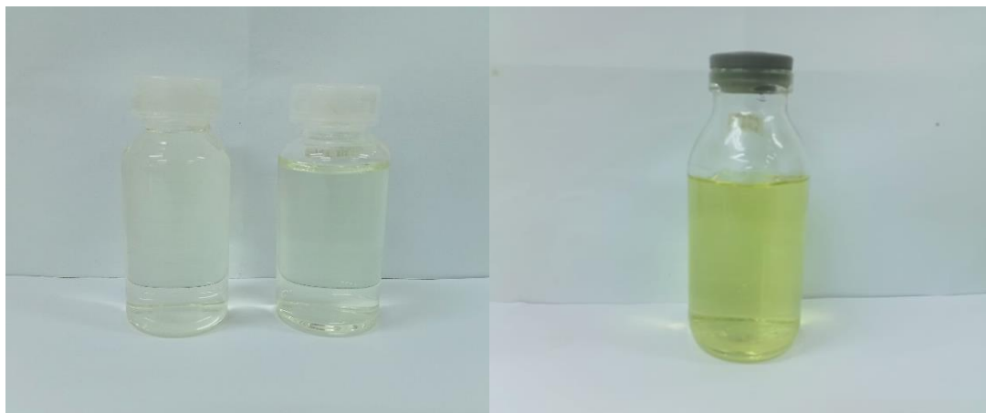
Filtrat elektrokoagulasi setelah destruksi dan diencerkan
