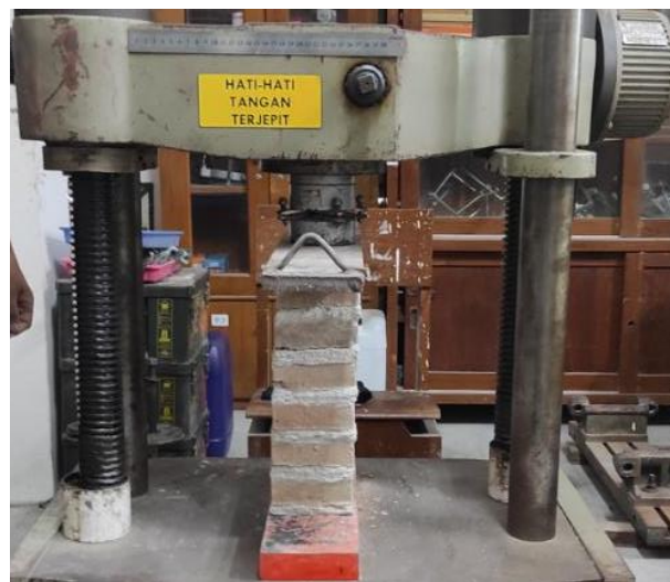
Gambar L-3.7 Pengujian Kuat Tekan Dinding
