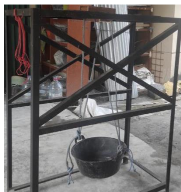
Gambar 4.4 Skema Realisasi Saat Pelaksanaan Pengujian Kuat Lekat Mortar
