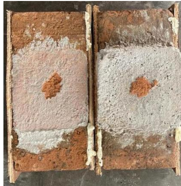
Gambar 4.5 Perkuatan Sisi Bata
