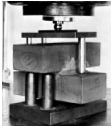
Gambar 4.3 Skema Rencana Sebelum Pelaksanaan Pengujian Kuat Lekat Mortar (Sumber: ASTM)
