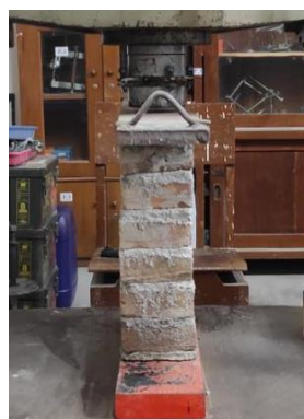
Gambar 4.6 Skema Pengujian Kuat Tekan Dinding Bata
