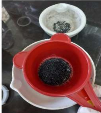
Karbon aktif dihaluskan dengan menggunakan saringan biasa
