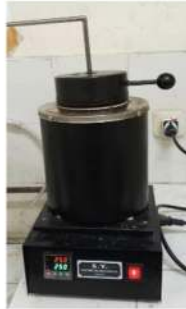
Hasil karbon aktif tersebut dipirolisis selama 2 jam pada suhu 250^{\circ}\text{C}
