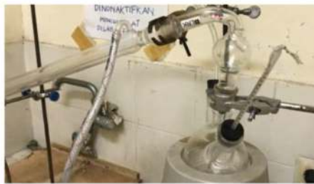
Proses konversi bioetanol dengan memasukkan bioetanol ke dalam labu leher tiga
