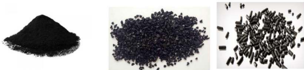
Gambar 6. Klasifikasi Bentuk Karbon Aktif (a) bubuk, (b) granula, (c) pellet
