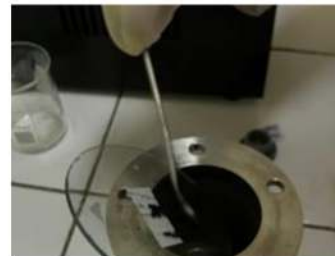
Komposit dimasukkan ke dalam reaktor
