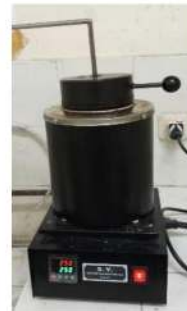
Pirolisis karbon aktif pada suhu 250\text{ }^\circ\text{C} selama 2 jam
