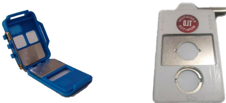
*Gambar 5. 3 APD Film Badge* untuk pekerja dan dosimeter radiasi untuk memantau dosis radiasi (Sumber : BPFK Surakarta)
