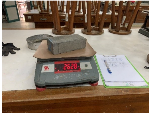
Gambar L-3.6 Proses Penimbangan Penguian Penyerapan Air Paving block
