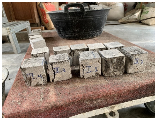
Gambar L-4.2 Benda Uji Hasil Uji Kuat Tekan
