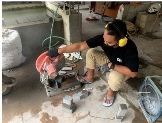
Gambar L-3.7 Pemotongan Paving Untuk Uji Kuat Tekan dan Keausan
