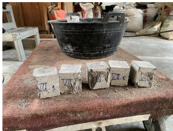
Gambar L-4.3 Benda Uji Hasil Uji Kuat Tekan
