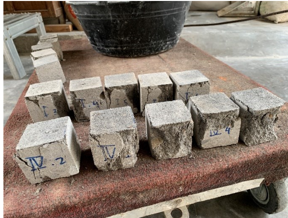
Gambar L-4.1 Benda Uji Hasil Uji Kuat Tekan
