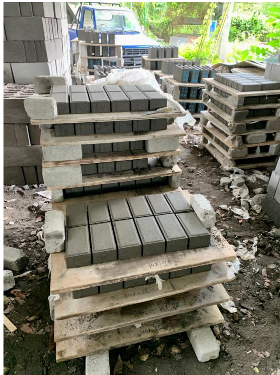
Gambar L-2.4 Penumpukan Benda Uji Setelah Dicetak
