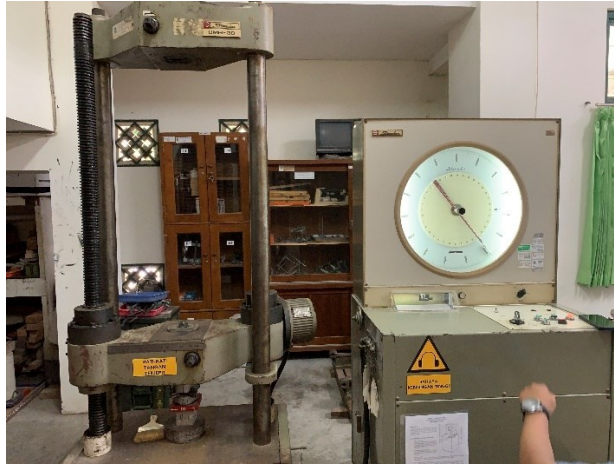
Gambar L-3.1 Pengujian Kuat Tekan Paving block
