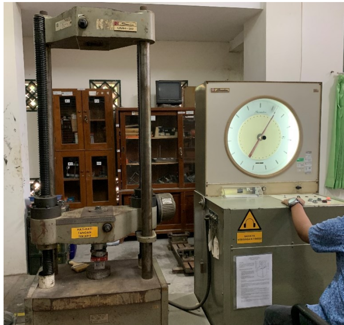
Gambar 4.22 Uji Kuat Tekan
