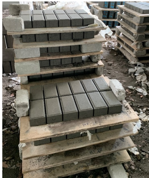
Gambar 4.20 Tumpukan Paving Setelah Pencetakan
