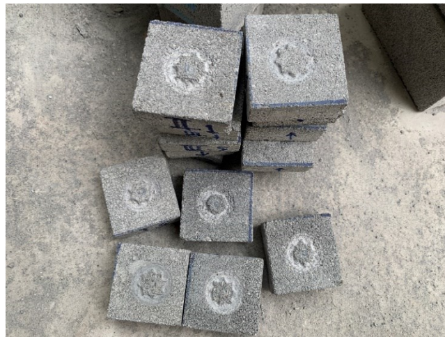
Gambar L-4.4 Benda Uji Hasil Uji Keausan
