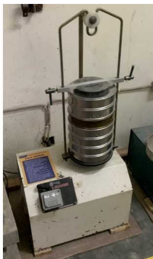
Gambar 4.8 Saringan Agregat Halus dan Mesin Penggetar
