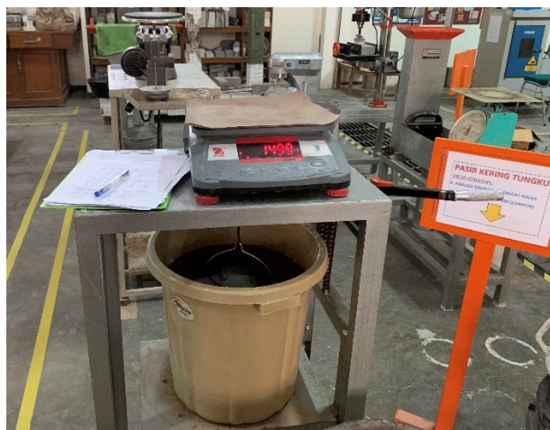
Gambar L-3.8 Penimbangan Semu Untuk Uji Rongga Dalam Paving
