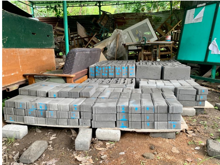
Gambar L-2.5 Penumpukan Benda Uji Setelah Mengeras
