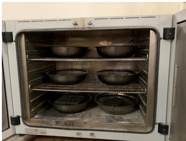
Gambar L-3.5 Proses Oven Pengujian Penyerapan Air Paving block
