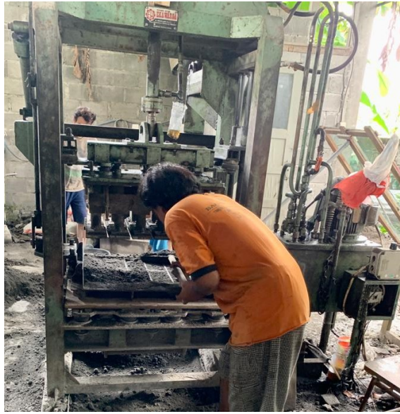
Gambar L-2.3 Proses Pencetakan Paving block
