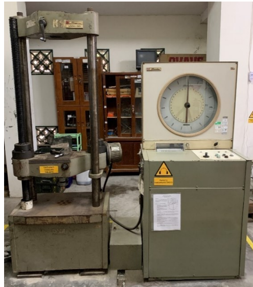
Gambar 4.14 Mesin Uji Kuat Tekan (UTM)
