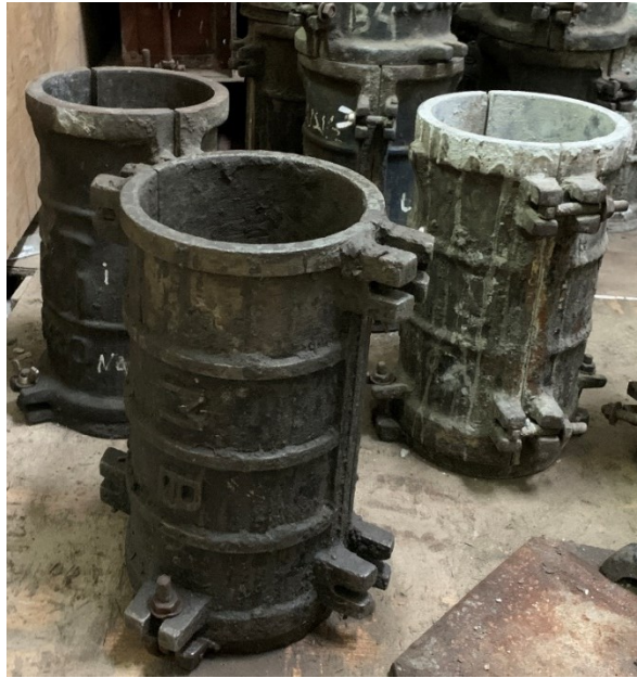
Gambar 4.7 Cetakan Silinder Beton
