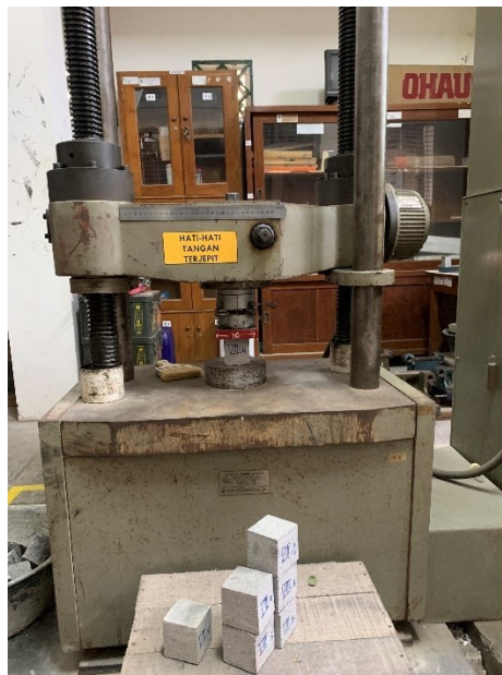
Gambar L-3.2 Uji Kuat Tekan Paving block
