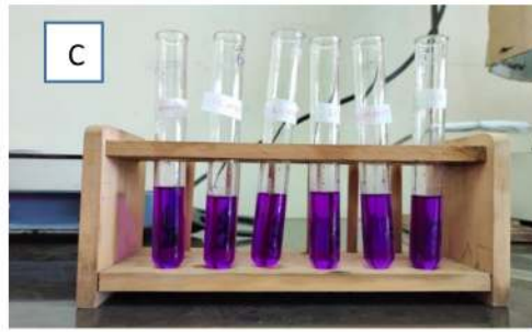
Gambar 18. Perubahan warna MV Terhadap Waktu Tanpa Penambahan H 2 O 2 pada Variasi Massa Katalis (a) 0,1 gram (b) 0,3 gram (c) 0,5 gram
