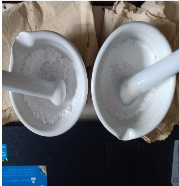
Gambar 19. Penggerusan ZrO_2 Dicampurkan dengan Y_2O_3
