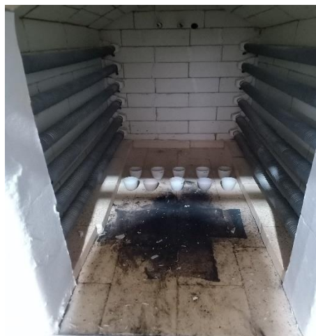
Gambar 20. Dikalsinasi pada Suhu 500^{\circ}C
