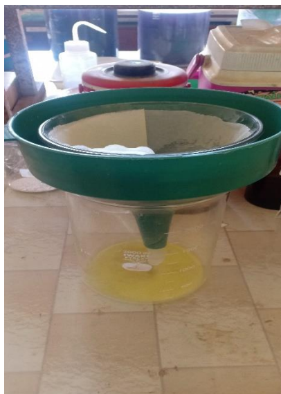
Gambar 13. Pelindian Frit Ditambahkan Dengan HCl
