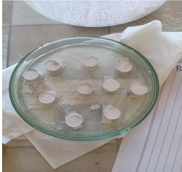
Gambar 21. Kompaksi Pada Tekanan 14.600 psi
