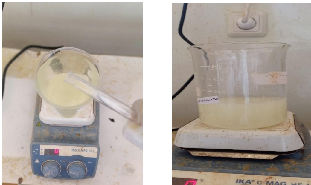
Gambar 15. ZOC Ditambahkan \text{NH}_4\text{OH} dan Distirer Selama 24 Jam
