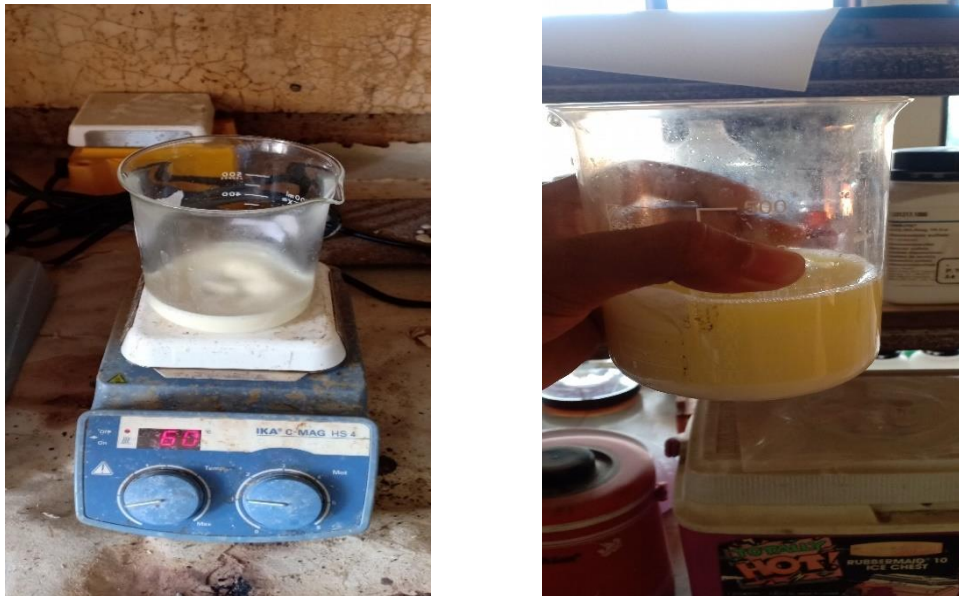
Gambar 13. Pelindian Frit Ditambahkan Dengan HCl
