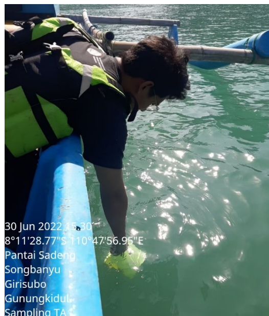
Gambar 3. 2 Pengambilan Sampel Menggunakan Gayung/Timba
