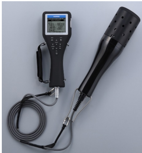
Gambar 3. 4 Instrumen Multiparameter yang Digunakan Saat Pengujian Parameter Lapangan
