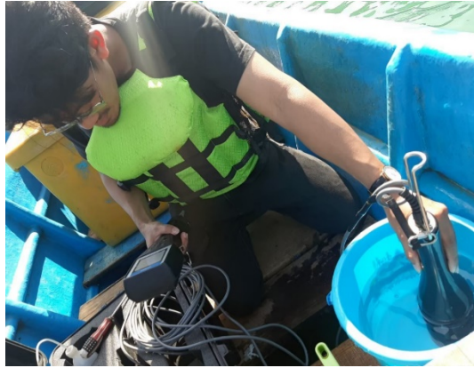
Gambar 3. 5 Pengujian Parameter Lapangan Pada Sampel Menggunakan Instrumen Multiparameter
