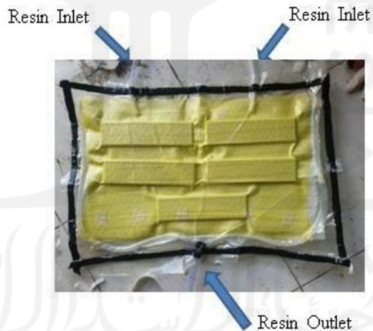
Gambar 3. 25 Memasukkan Semua Bahan Ke dalam Vacuum Bag
