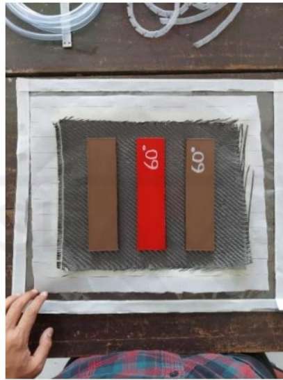
Gambar 3. 22 Susunan Komposit Sandwich
