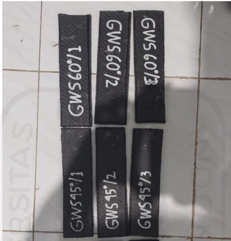
Gambar 3. 28 Hasil Core PLA Setelah Vacuum Infusion
