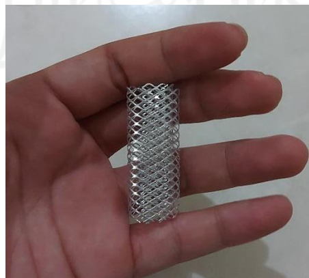
Gambar 3- 42 Proses Pembuatan Replika Stent Graft
