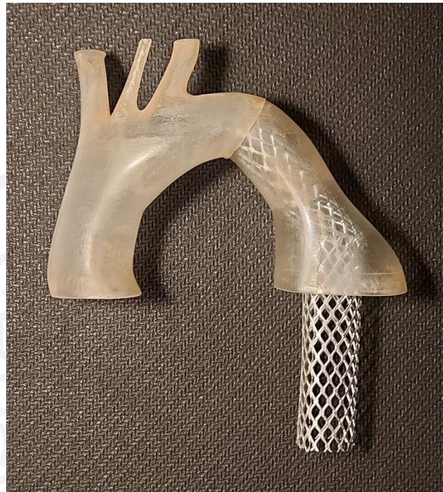
Gambar 4- 37 Hasil Pemasangan Stent Graft Pada Bagian Descending Aortic Aneurysm
