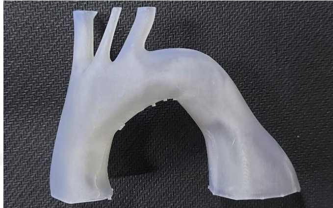
Gambar 4- 42 Hasil Pencetakan Ketiga Thoracic Aortic Aneurysm
