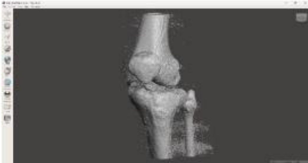
Gambar 3- 4 Hasil file STL yang masih memiliki noise setelah di export dari 3D Slicer
