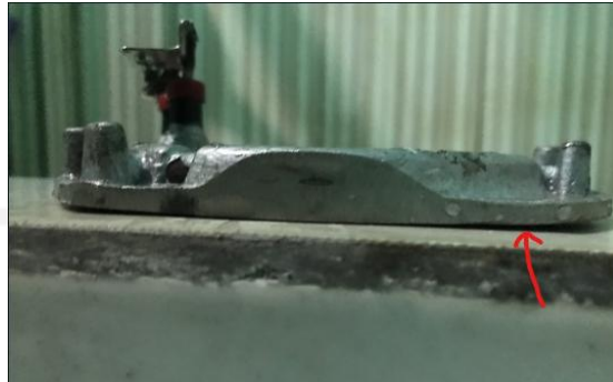
Gambar 4- 26 Bagian pemanas yang tidak rata
