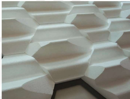
Gambar 2–1 Dentikel kulit hiu buatan berbahan busa EPS [1].
