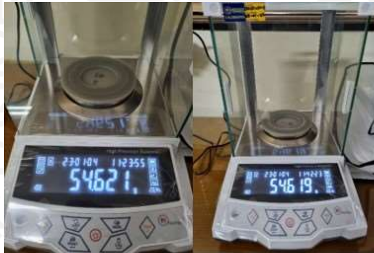
Gambar 3–31 Penimbangan spesimen sebelum dan sesudah pengujian.
