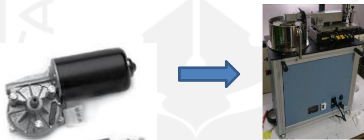
Gambar 3-3 Tribometer menjadi pengganti motor wiper yang ada pada mobil.
