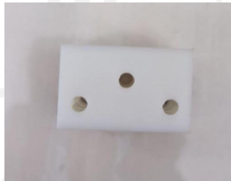
Gambar 3- 5 Pencekam setelah dicetak menggunakan printer 3D.
