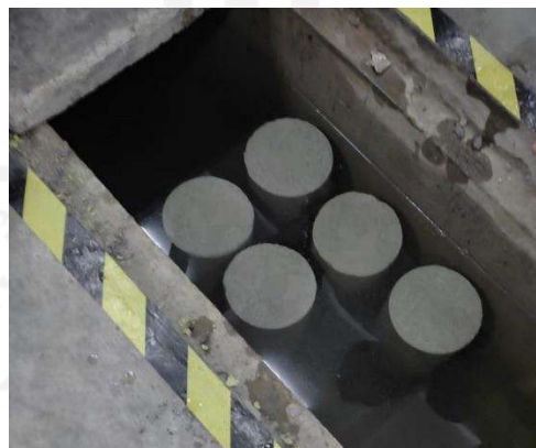
Gambar 4. 1 Perawatan beton dengan perendaman
