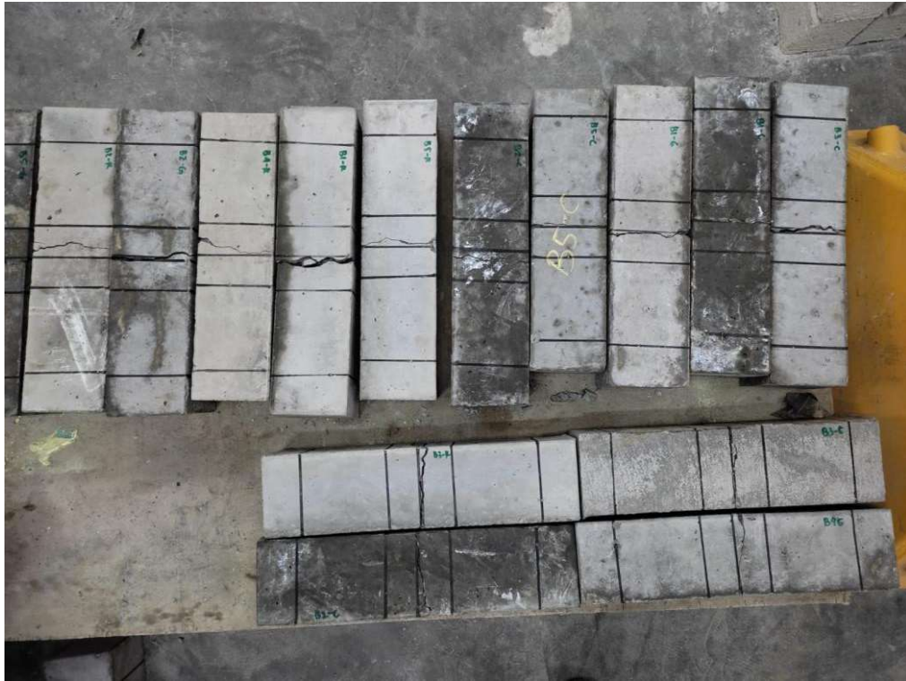
Gambar L-12. 7 Kerusakan benda uji balok setelah pengujian
