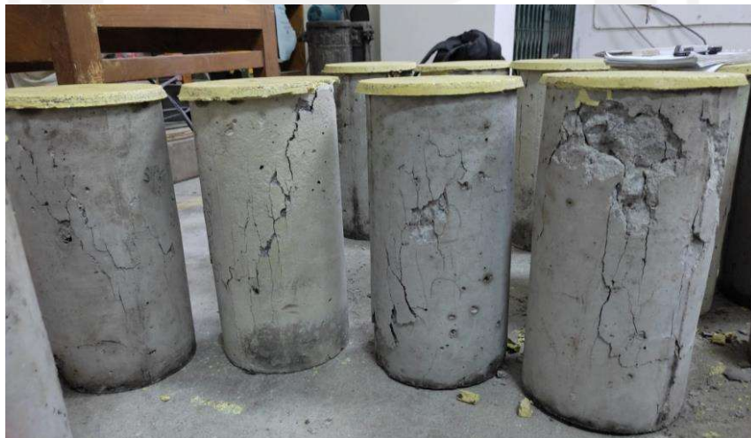
Gambar L-12. 6 Kerusakan benda uji silinder setelah pengujian
