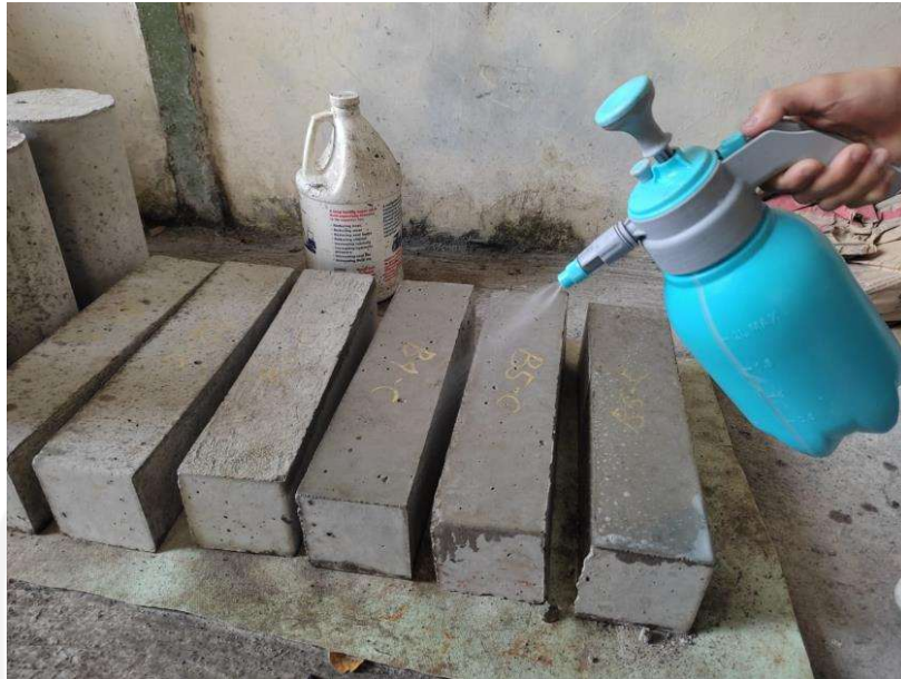
Gambar L-11. 3 Penyemprotan curing compound
