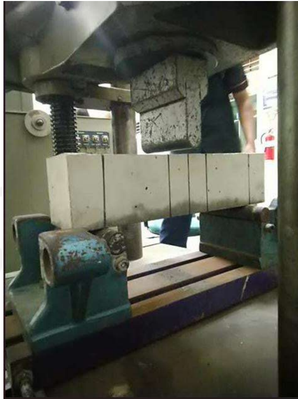
Gambar L-12. 5 Pengujian kuat lentur
