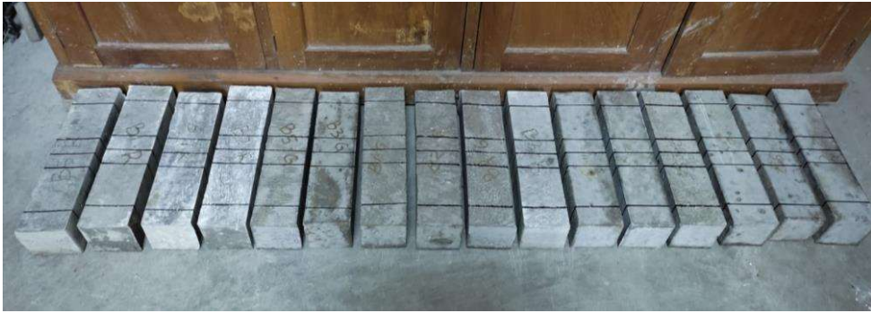
Gambar L-12. 3 Proses pemberian batas benda uji balok
