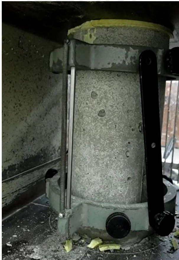
Gambar L-12. 4 Pengujian kuat tekan dan modulus elastisitas
