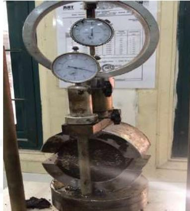
*Alat Pengujian Marshall dan Immersion*
