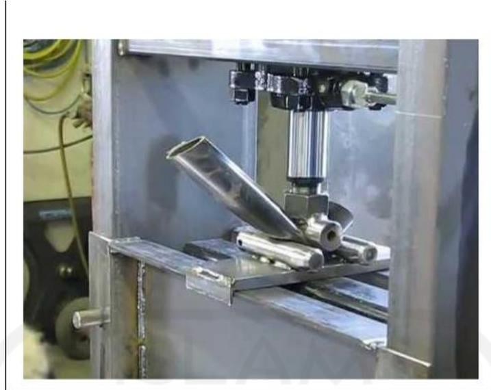
Gambar 5. 2 Mesin Press Hidrolik
