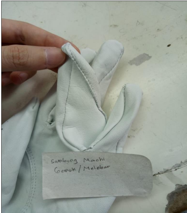
Produk defect: sambung machi terlalu lebar
