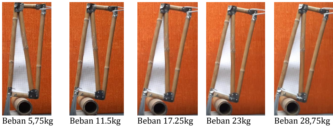
Gambar 5. Pergeseran Deformasi pada modul Sumber: Kajian Penulis tahun 2022
