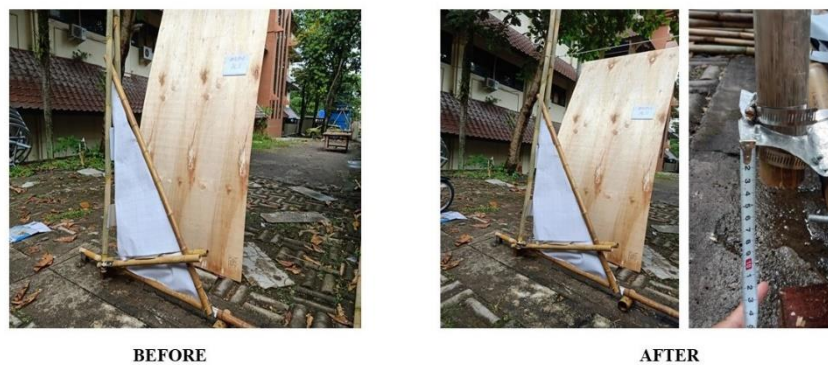
Gambar 3.8 Kondisi maket sebelum dan sesudah pengujian 20kg Sumber : dokumentasi pribadi
