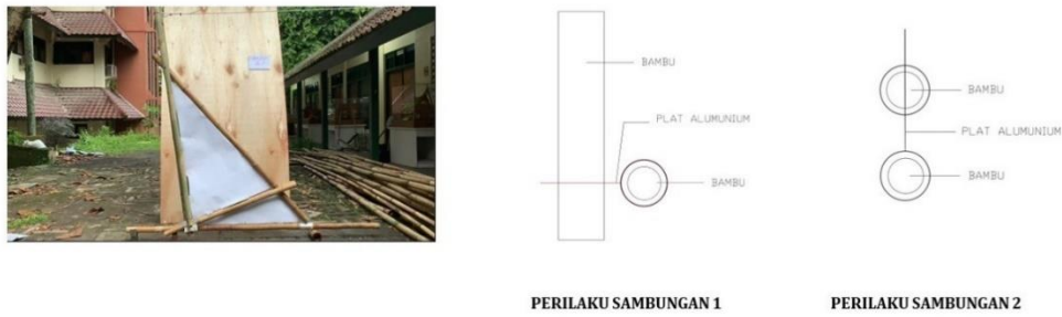
Gambar 3.3 Pengujian dengan beban 10kg Sumber: dokumentasi pribadi
