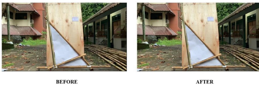
Gambar 3.4 Kondisi maket sebelum dan sesudah pengujian 10kg Sumber: dokumentasi pribadi
