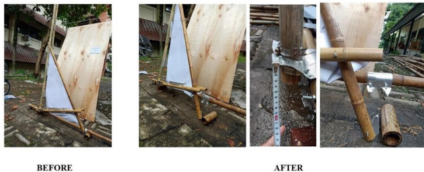
Gambar 3.10 Kondisi maket sebelum dan sesudah pengujian 25kg
