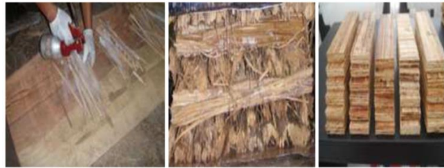
Gambar 2. Proses pengaplikasian perekat pada zypher dan papan yang sudah dipadatkan Sumber: Wardani, 2015
