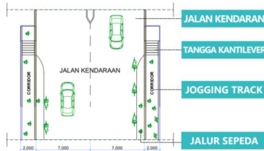
Gambar 8. Skematik Denah Partial Jembatan Dompok (Sumber:Penulis,2020)
