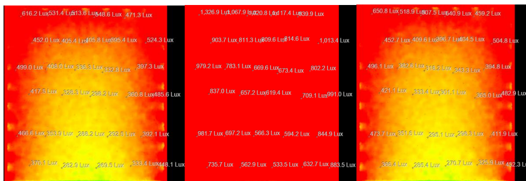
Gambar 15 : Hasil Simulasi Model 3 dengan ketinggian 1500 pada jam 08.00, 12.00, dan 16.00
