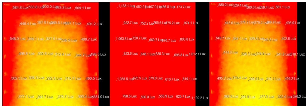
Gambar 12 : Hasil Simulasi Model 2 dengan ketinggian 2500 pada jam 08.00, 12.00, dan 16.00
