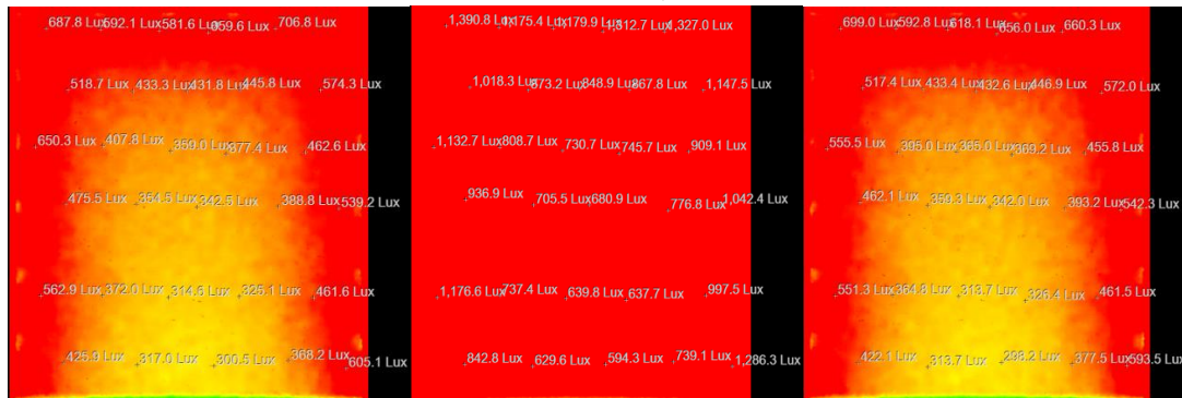
Gambar 11 : Hasil Simulasi Model 2 dengan ketinggian 1500 pada jam 08.00, 12.00, dan 16.00
