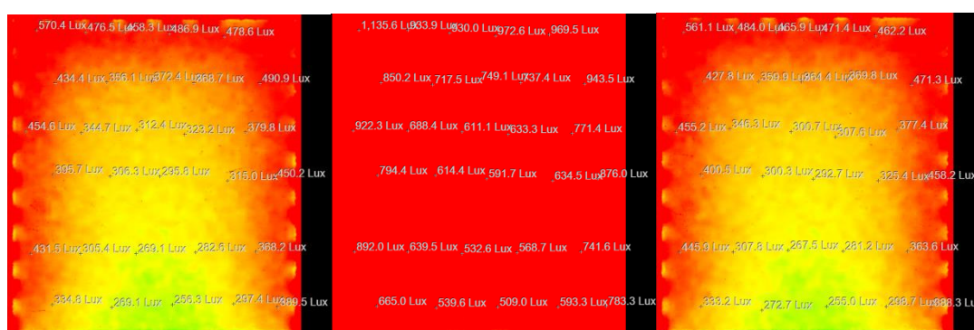
Gambar 16 : Hasil Simulasi Model 3 dengan ketinggian 2500 pada jam 08.00, 12.00, dan 16.00
