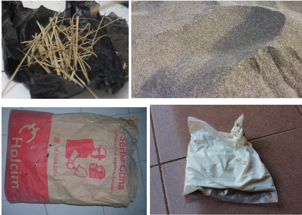
Gambar 3 Bahan penelitian : Serat bambu, pasir, semen, PVA
