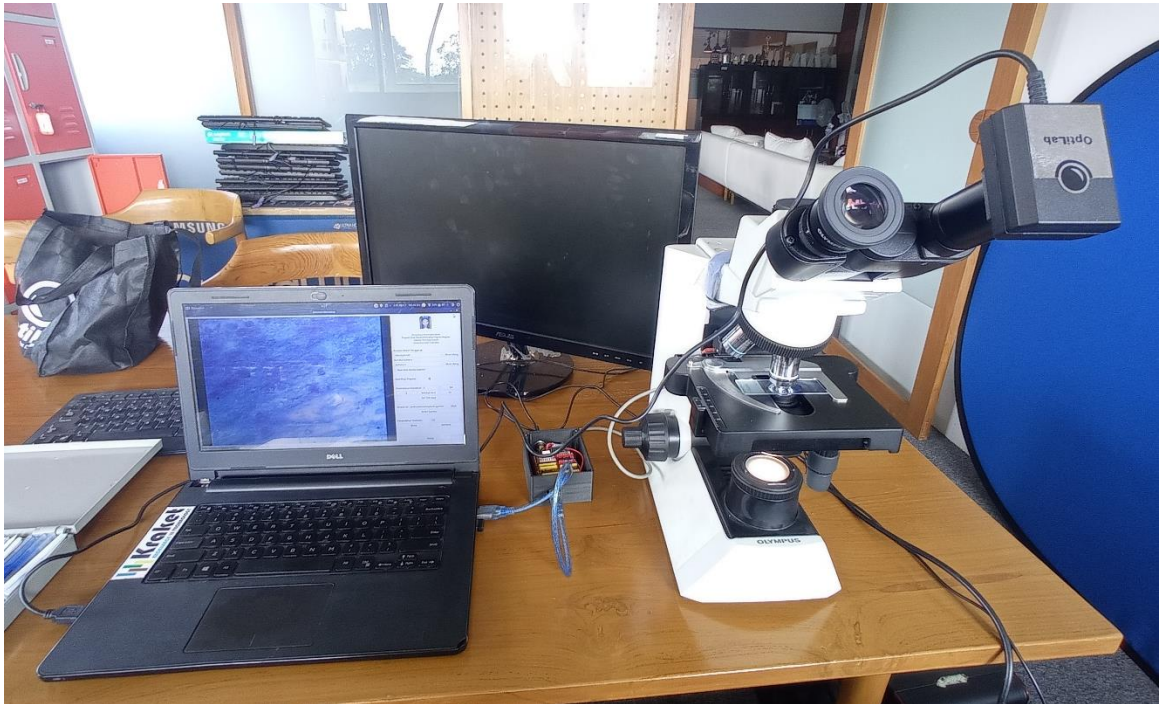
Gambar 4.13. Integrasi motor kontrol, kamera dan komputer.
