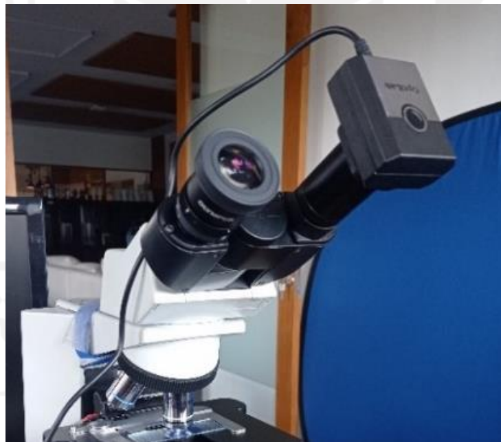
Gambar 4.12. Posisi kamera pada lensa mikroskop.
