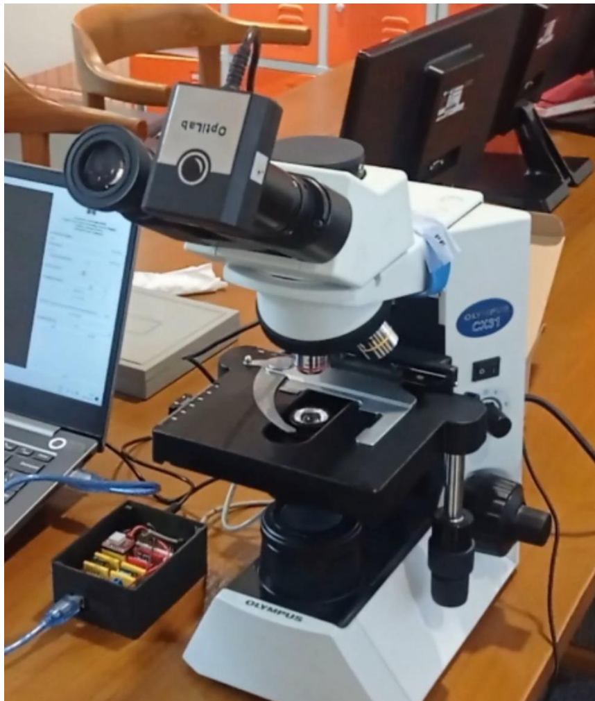
Gambar 3.4. Mikroskop dengan tambahan kamera pada lensa pengamatan
