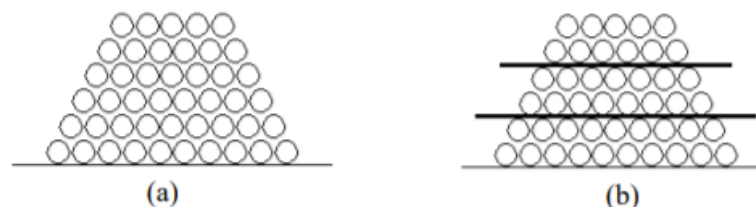
Gambar 3.9 (a) Tumpukan Pasir dengan Sudut Lereng Asli (b) Tumpukan Pasir dengan Lereng yang Diperkuat
