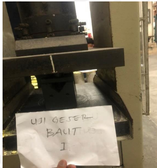
Gambar 5. 6 Pengujian Kuat Geser Baut Sampel 1
