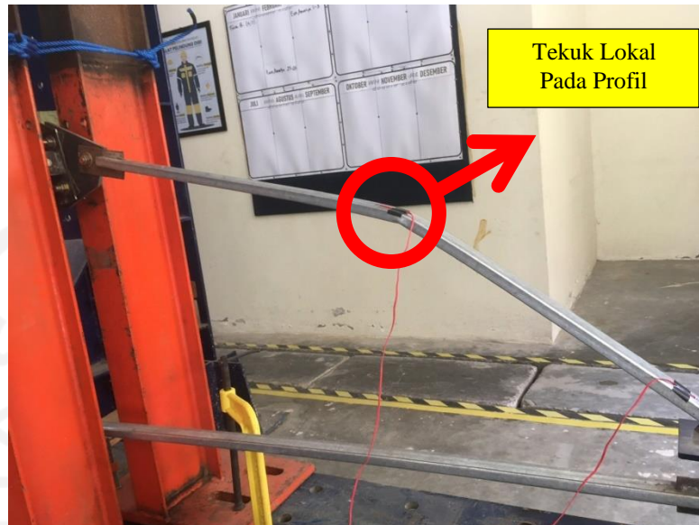
Gambar 5. 12 Kondisi Sampel Uji 1 Setelah Pengujian
