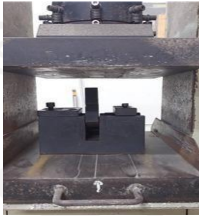
Gambar 4. 11 Set Up Pengujian Kuat Geser Baut
