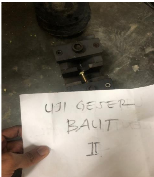
Gambar 5. 7 Pengujian Kuat Geser Baut Sampel 2
