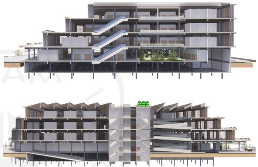
Gambar x.x Skema ramp bangunan Sumber : Penulis (2022)
