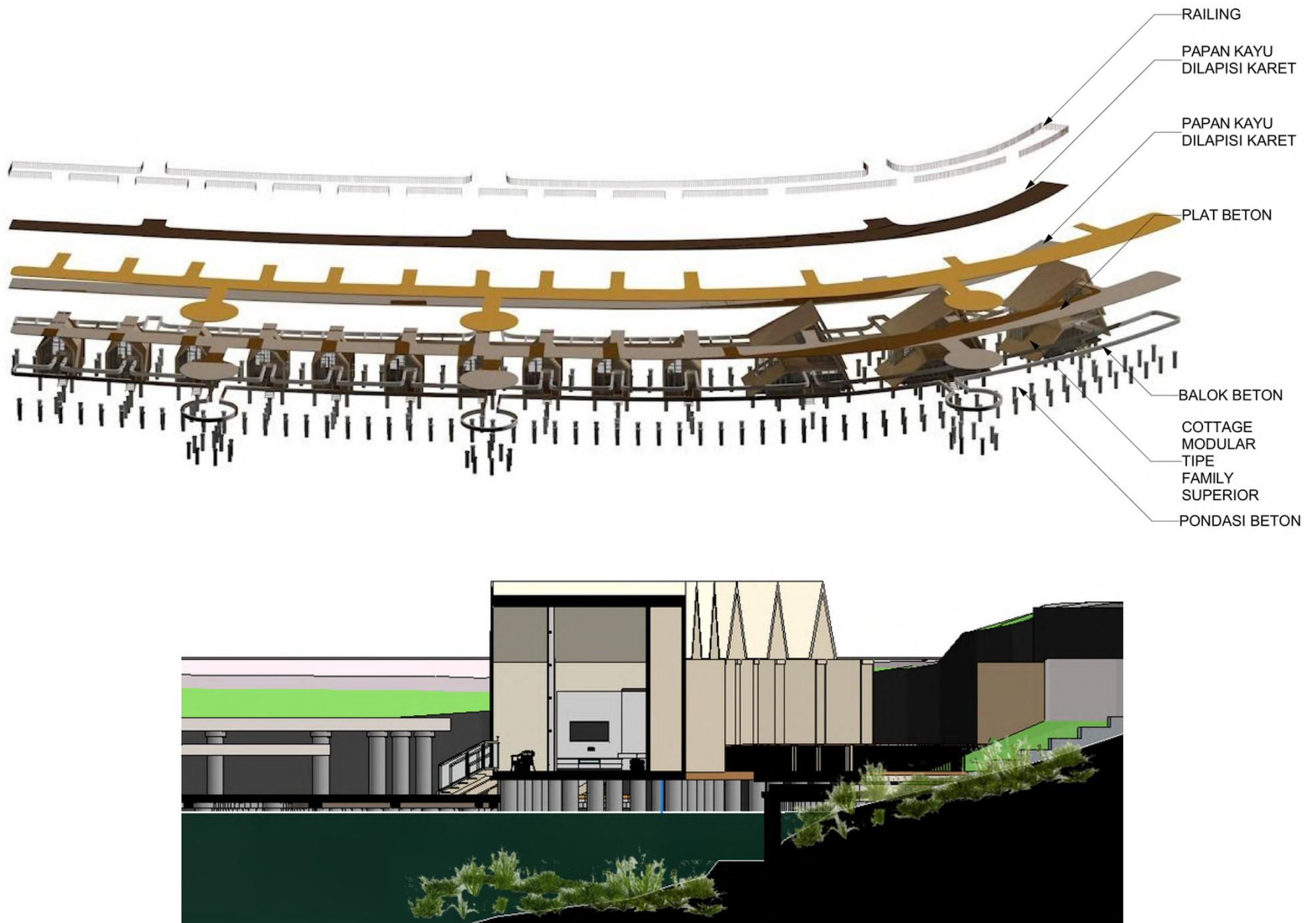
**Gambar 4.1.4** Skematik Sistem Struktur Bangunan Tepi Danau
