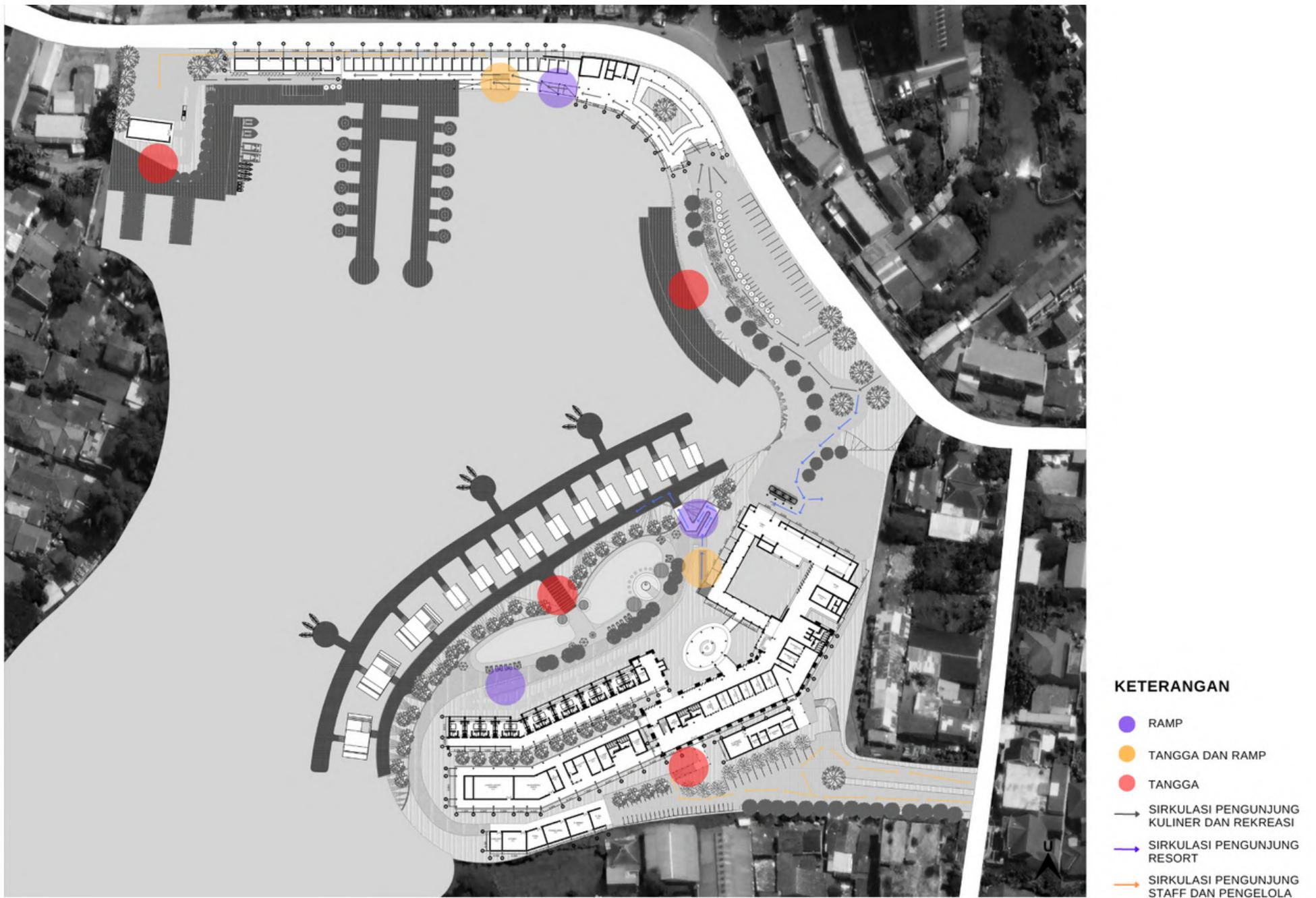
**Gambar 4.1.4** Skematik SistemTransportasi Vertikal dan Akses Difabel
