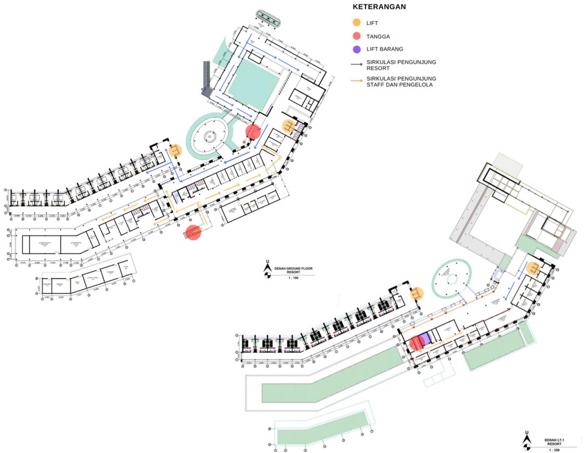
**Gambar 4.1.4 Skematik Sistem Transportasi Vertikal dan Akses Difabel**
