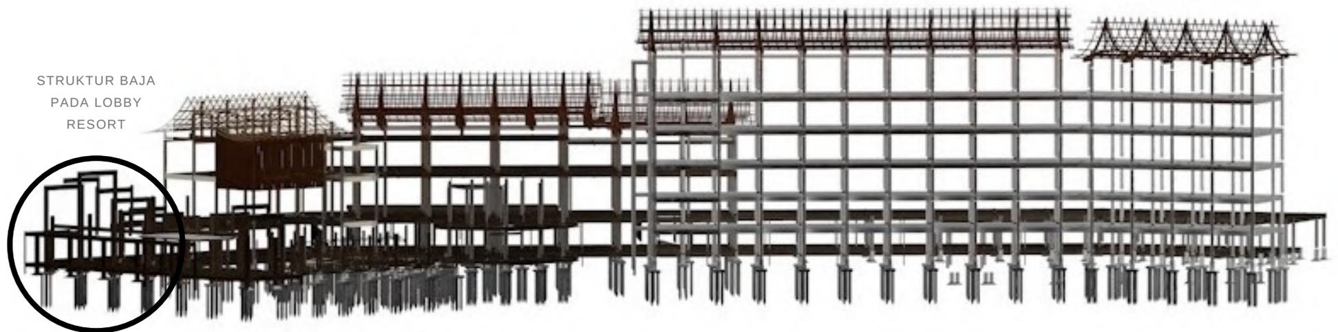
Sistem struktur pada bangunan resort (fasilitas dan kamar hotel) dan kuliner menggunakan sistem grid bentang paling lebar yaitu 8 m dengan kolom beton 4 ukuran 40 x 40 cm Rancangan yang berada di pinggir danau dan lahan basah digunakan pondasi tiang pancang dengan kedalaman 4-5 meter untuk menahan beban bangunan dan tidak merusak lahan.
