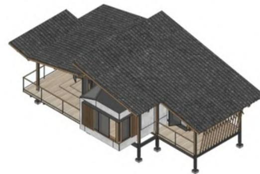
Tipe besar benar-benar dipisahkan oleh struktur sistem rangka atap dan kotak dalam ruangan. Sistem atap terlihat jelas, termasuk segmen baja-kayu, sambungan antara komponen kayu dan batang struktural baja overhead di bagian bawah.
