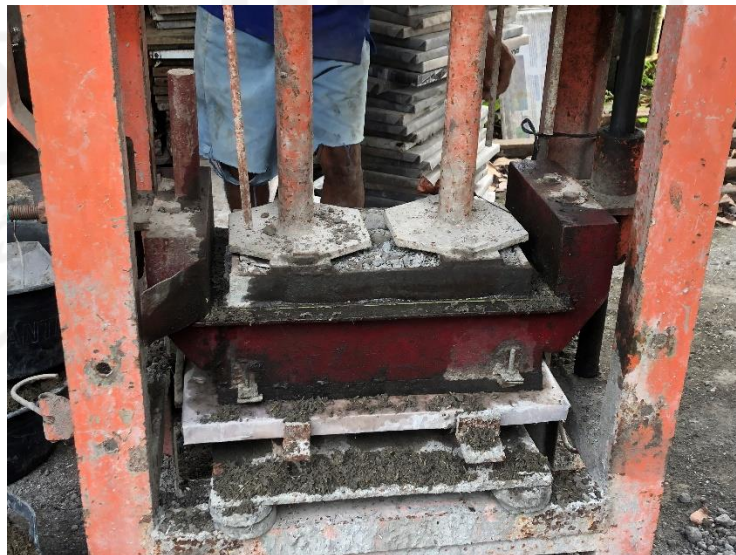
Gambar 4.9 Adonan Batako di Mesin Press
