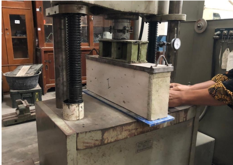
Gambar L 2. 3 Pengujian Kuat Desak Bata Ringan Falcon
