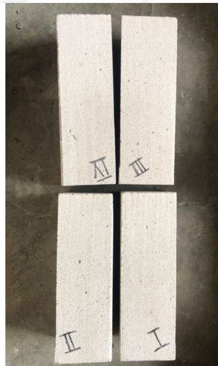
Gambar L 3. 2 Bata Ringan Falcon Setelah Dipotong
