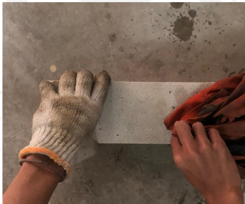
Gambar L 3. 4 Penyekaan Permukaan Benda Uji
