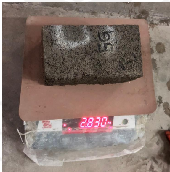
Gambar L 3. 6 Penimbangan Benda Uji Kondisi Basah
