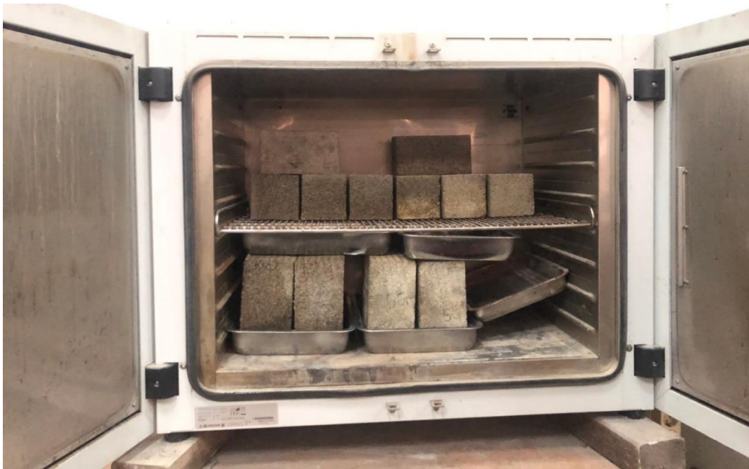
Gambar L 3. 5 Pengeringan Benda Uji dengan Oven
