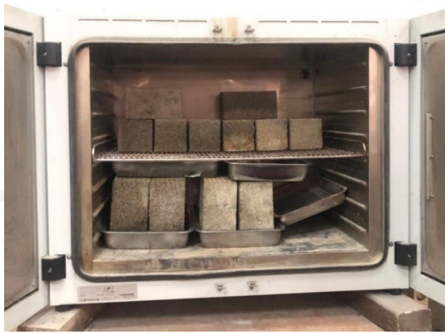
Gambar 4.14 Benda Uji di dalam Oven
