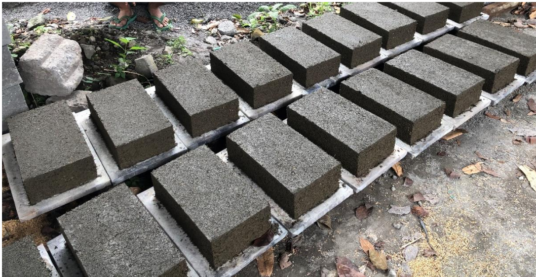
Gambar L 1. 1 Batako Sekam Padi Tambahan Fly Ash Setelah Dicetak
