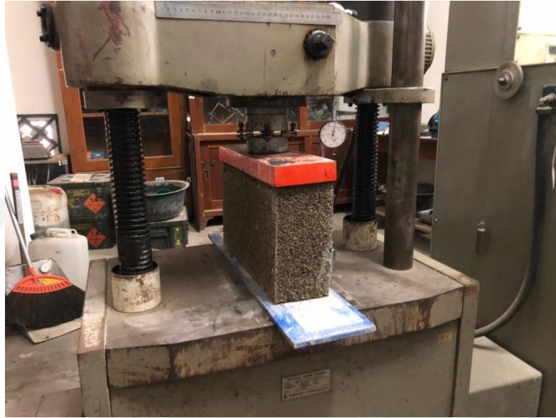
Gambar L 2. 1 Pengujian Kuat Desak Batako Sekam Padi
