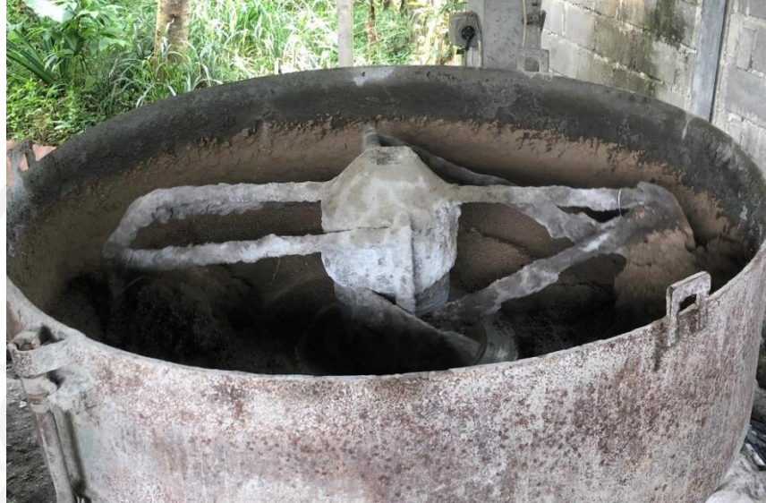
Gambar 4.7 Pengadukan Bahan Campuran Oleh Mixed Machine
