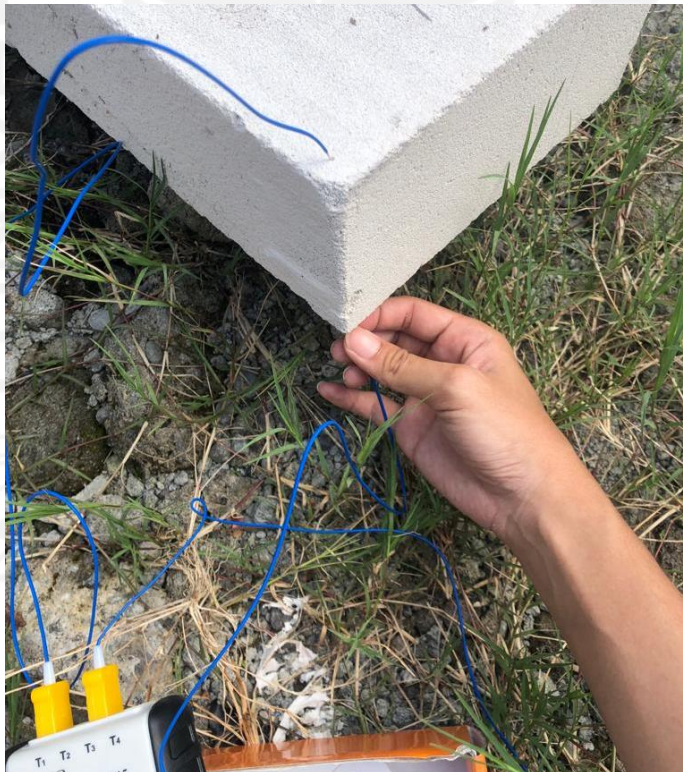
Gambar L 4. 2 Pengukuran Suhu Menggunakan Thermocouple
