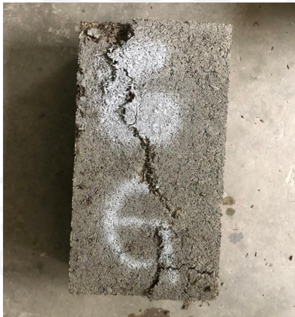
Gambar L 2. 2 Batako Sekam Padi Setelah Pengujian Kuat Desak
