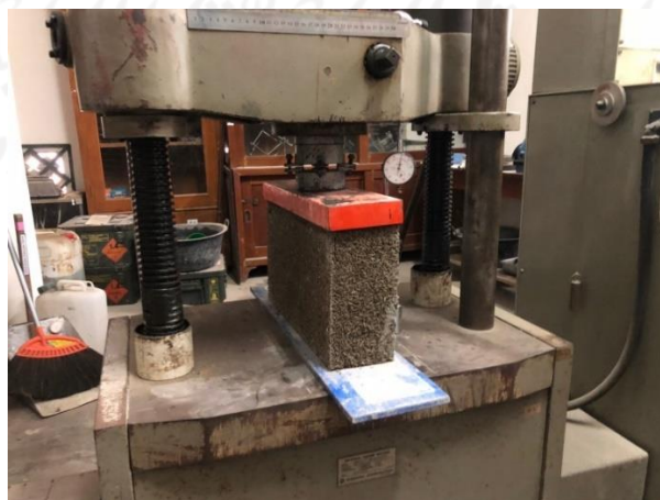
Gambar 4.12 Pengujian Kuat Desak Pada Batako Sekam Padi
