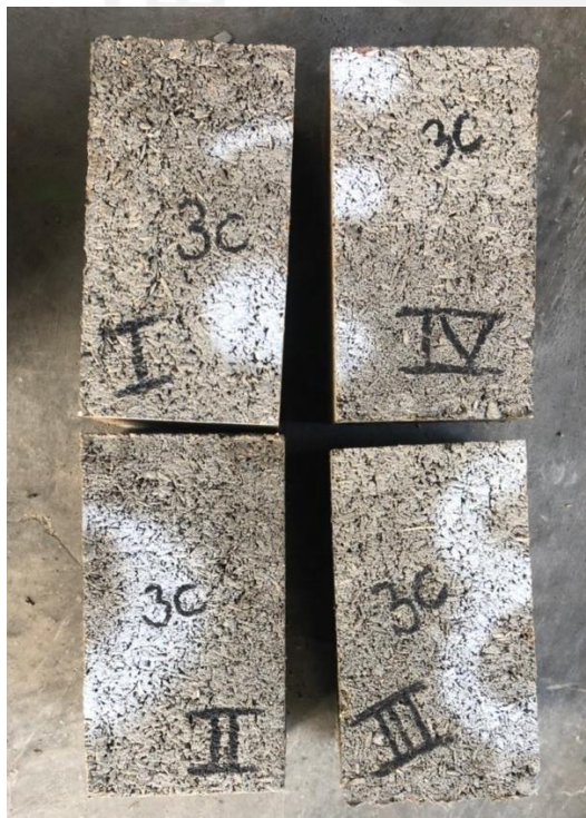
Gambar L 3. 1 Batako Sekam Padi Variasi III Setelah Dipotong
