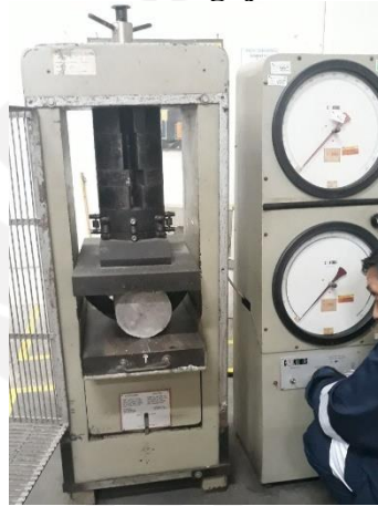
Gambar L-3.14 Proses Pengujian Kuat Tarik Beton
