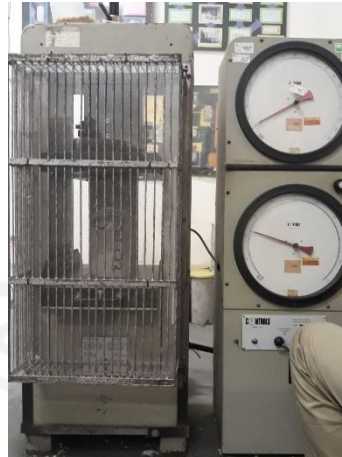
Gambar L-3.13 Proses Pengujian Kuat Tekan Beton
