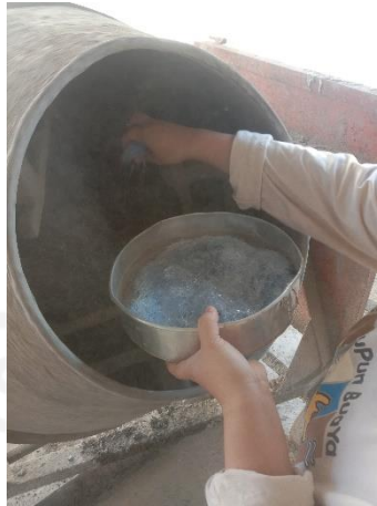
Gambar L-3.4 Penambahan PET ke dalam Campuran Beton
