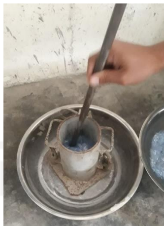
Gambar 5.10 Proses Pengujian Berat Volume Padat Cacahan Botol Polyethylene Terephthalate (PET)
