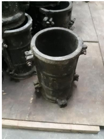
Gambar L-1.9 Cetakan Silinder Beton
