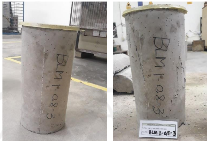
Gambar L-3.16 Hasil Pengujian Kuat Tekan Beton
