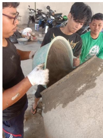
Gambar L-3.3 Pencampuran Material Penyusun Beton
