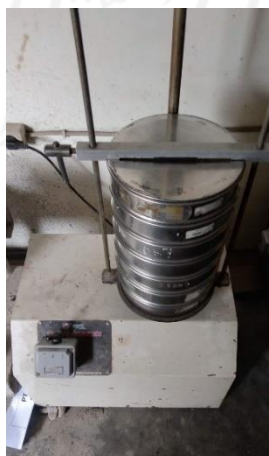
Gambar 5.2 Proses Pengujian Analisis Saringan Agregat Halus
