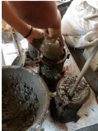
Gambar L-3.6 Pengisian dan Pematatan Beton pada Cetakan
