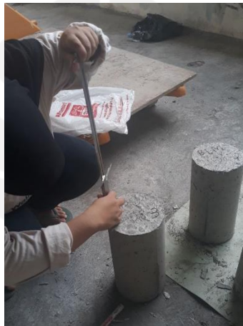
Gambar L-3.8 Pengukuran Dimensi Benda Uji
