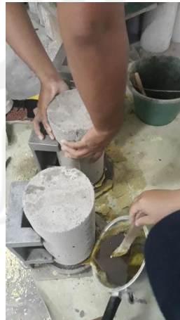
Gambar L-3.12 Proses Melapisi Permukaan Beton dengan Belerang
