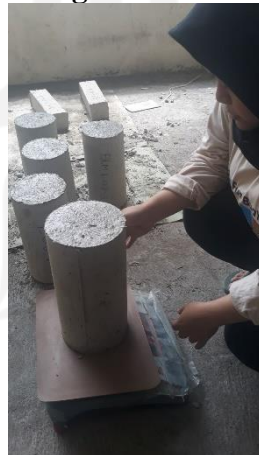
Gambar L-3.9 Penimbangan Benda Uji
