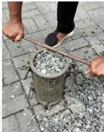
Gambar 5.8 Proses Pengujian Berat Volume Agregat Kasar
