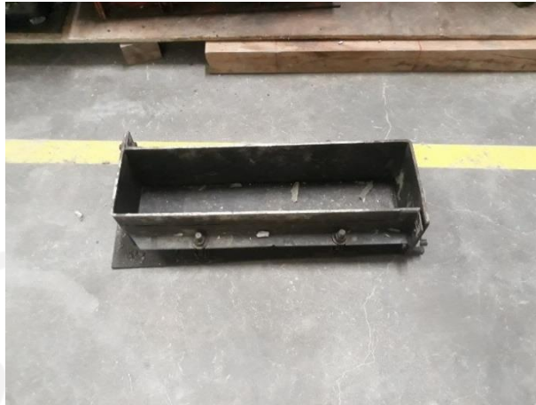
Gambar L-1.10 Cetakan Balok Beton
