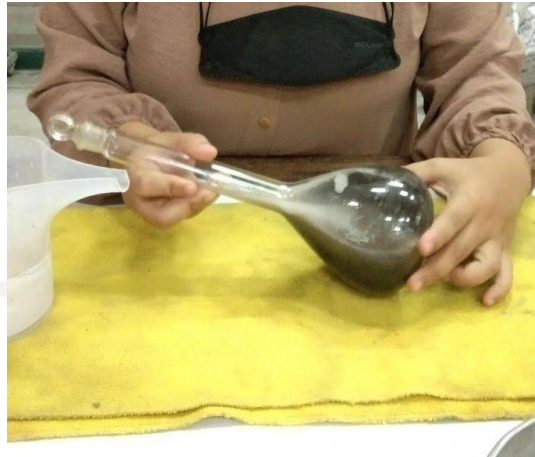
Gambar 5.1 Proses Pengujian Berat Jenis dan Penyerapan Agregat Halus
