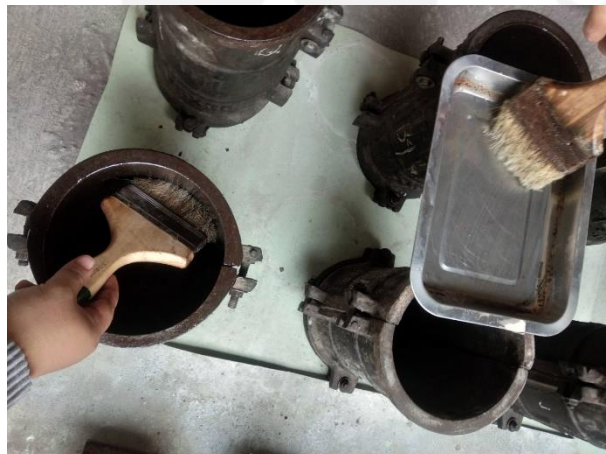
Gambar L-3.2 Pelumasan pada Cetakan Silinder Beton
