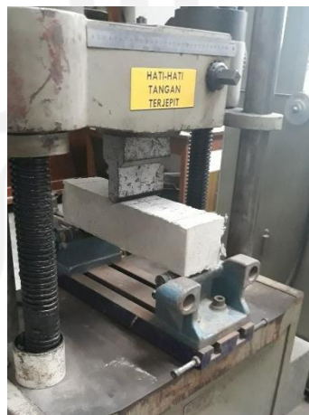
Gambar L-3.15 Proses Pengujian Kuat Lentur Beton
