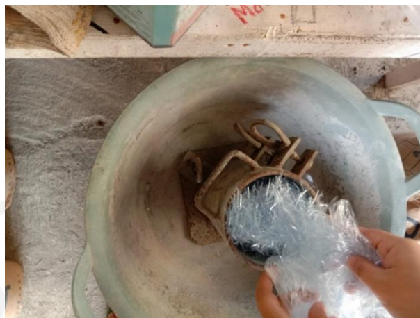
Gambar 5.9 Proses Pengujian Berat Volume Gembur Cacahan Botol Polyethylene Terephthalate (PET)
