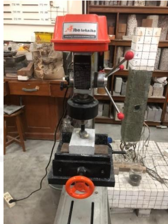
Gambar 3. 8 Alat Pengujian Ketahanan Aus Paving Block (Sumber: Data Pribadi)
