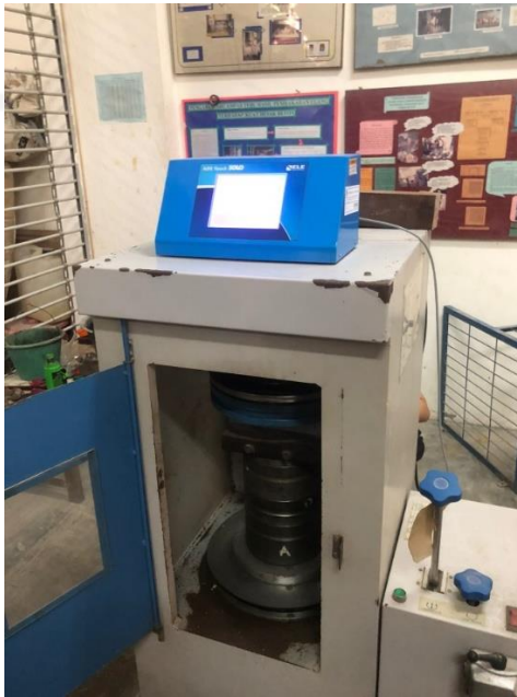
Gambar L 4.1 Pengujian Kuat Tekan
