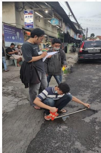
Gambar 4.4 Pengukuran Dimensi Pothole
